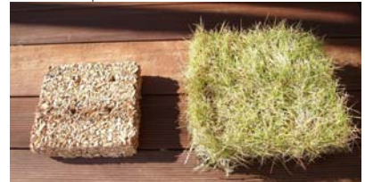
左：間伐材を原材料としたエコ素材の基盤（車いすがめり込まない）。右：左の基盤に芝生を載せ根付かせます（植物の蒸散作用により気化熱が奪われ、また植物や基盤が断熱材となるため、屋上の温度は20℃以上低下します）。
